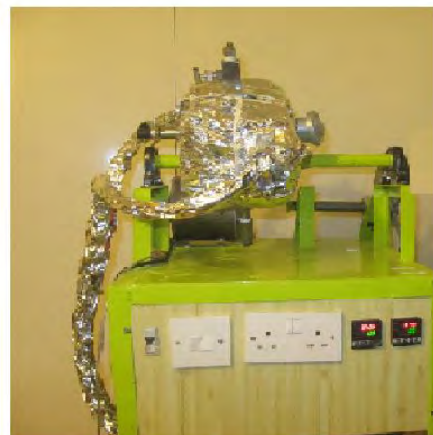
شکل ۲ تصویر و شماتیک دستگاه مورد استفاده برای تشکیل و تجزیه هیدرات
